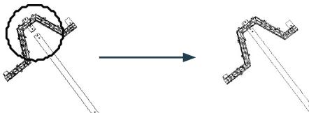
3. Установите держатель дождемера с короткой стороны держателя передатчика. Закрепите их с помощью винта PM3,0x25 мм и винтовой гайки M3. Затем установите дождемер на держатель дождемера и зафиксируйте его двумя винтами PA3,0x8 мм.
